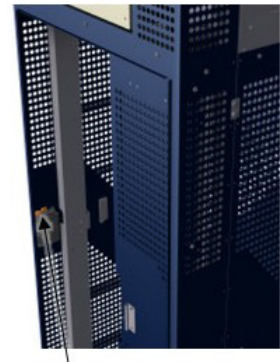
Interne manuelle Entsperrung der Schutzverriegelung von L95
